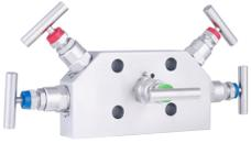
Progettati per essere utilizzati insieme a trasmettitori e strumenti di pressione differenziale. I collettori di base a 3 vie sono costituiti da due valvole di isolamento e da una valvola di compensazione in una singola unità compatta.
