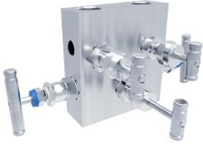
Progettati per essere utilizzati insieme a trasmettitori e strumenti di pressione differenziale. I collettori di base a 3 vie sono costituiti da due valvole di isolamento e da una valvola di compensazione in una singola unità compatta.
