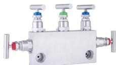
Progettati per essere utilizzati insieme a trasmettitori e strumenti di pressione differenziale. I collettori di base a 3 vie sono costituiti da due valvole di isolamento e da una valvola di compensazione in una singola unità compatta.
