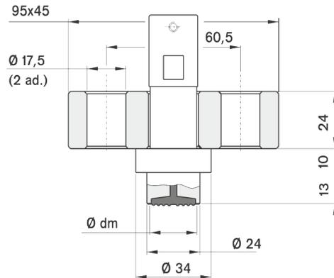
**Kelepçe Bağlantılı : DN 24 PN 600 bar**
