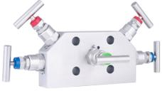
Diseñados para permitir el acceso a todas las vías en una sola estructura compacta con una facilidad de operación óptima. El colector de 5 vías consta de 2 válvulas de aislamiento de presión, 2 válvulas de purga/válvulas integrales para la purga y 1 válvula de ecualización. El colector de válvulas de 5 vías también se usa en los transmisores e instrumentos de presión diferencial.
