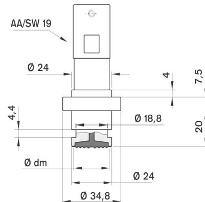
**Kelepçe Bağlantılı : DN 24 PN 600 bar**
