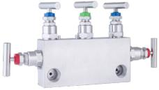
Konzipiert für Zugang zu allen Richtungen in einer einzigen kompakten Einheit mit optimaler Bedienungsfreundlichkeit. Der Haupt-5-Wege-Ventilblock besteht aus zwei Druckabsperrentilen, zwei integralen Abfluss-/Entlüftungsventilen zum Spülen und ein
